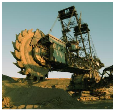
Riesenbagger sind im Braunkohlebergbau übliche Arbeitsgeräte.
